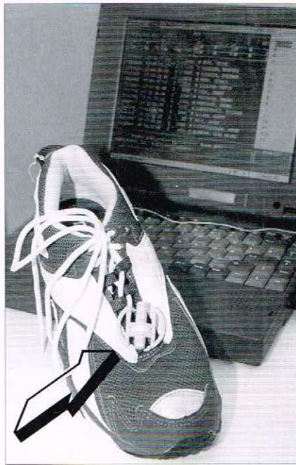
**DIESE „SCHNALLE“ am Schuh ist ein Mikrochip. Beim Passieren der Ziellinie registrieren dort ausgelegte Antennen Chip-Nummer und Laufzeit. Bild: PLOHE**
